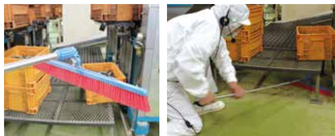
ブラシを手前側に折り曲げる事で、機械と床の隙間も簡単に掃除可能に
