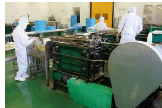
とろろ昆布製造工程。切削する工程で昆布の削りかすが床に落ちてしまう
