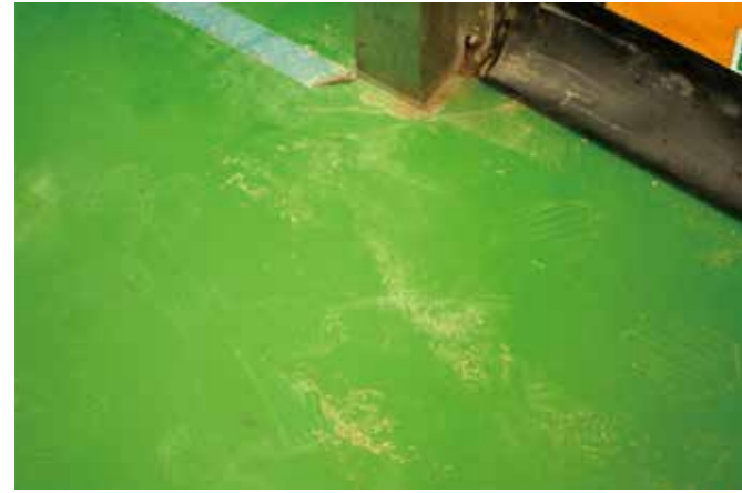
加工場の出入り口付近の床には昆布の削りかす、塵が付着してしまう
